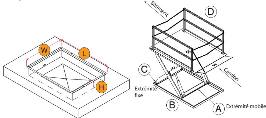
\*Capacité basées sur des charges distribuées uniformément. Capacité de charge sur essieu roulant simple : 80 % de la capacité nominale aux extrémités et 50 % de la capacité nominale sur les côtés - selon le modèle.
